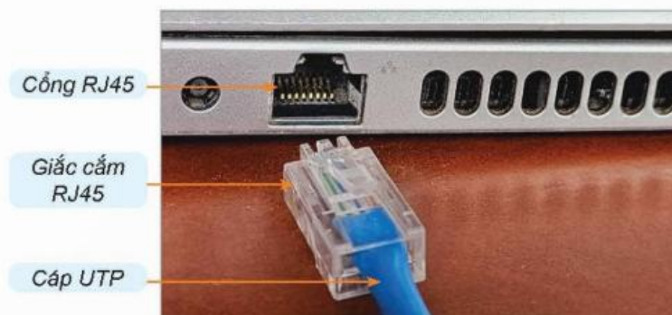
Hình 3.8. Giắc cắm và cổng RJ45
