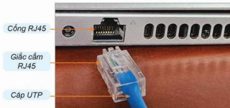
Hình 3.8. Giắc cắm và cổng RJ45
