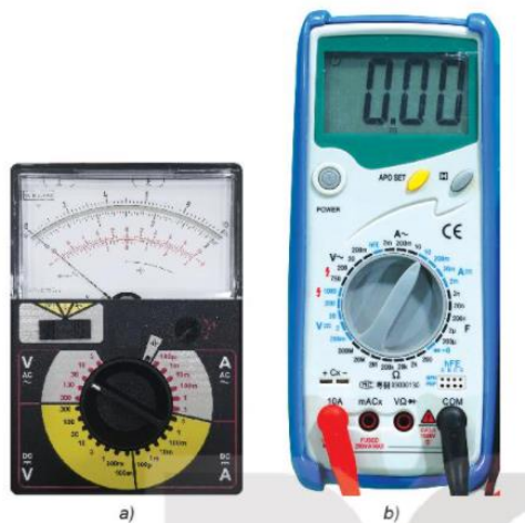
Hình 2.6. Đồng hồ đo điện đa năng kim (a) và đồng hồ đo điện đa năng hiển số (b)
