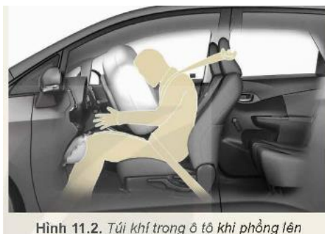
Hình 11.2. Túi khí trong ô tô khi phồng lên
