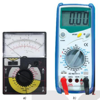
Hình 2.6. Đồng hồ đo điện đa năng kim khung quay a) và đồng hồ đo điện đa năng hiện số b)
