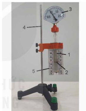
Hình 9.4. Thí nghiệm về quá trình đẳng nhiệt
