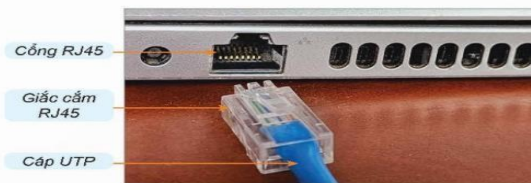
Hình 3.8. Giắc cắm và cổng RJ45
