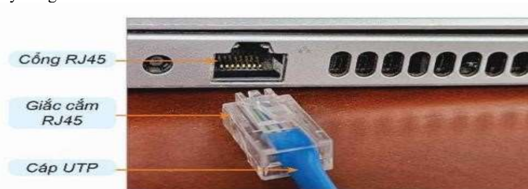
Hình 3.8. Giắc cắm và cổng RJ45
