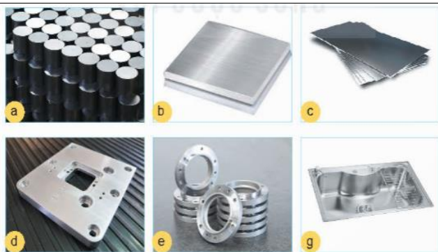
Hình 11.5. Hình ảnh phôi và sản phẩm qua công đoạn gia công tạo hình
