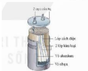
Hình 21.5. Cấu tạo của tụ điện hình trụ
