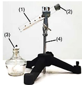
Hình 2.2. Thí nghiệm về mối liên hệ giữa nội năng của vật với năng lượng của các phân tử khí
